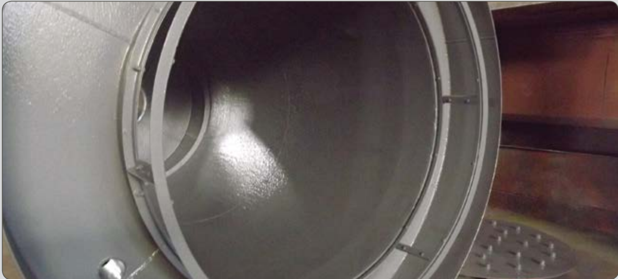
PROTEÇÃO DE BOMBA COM PLASTEEL ALTA RESISTÊNCIA QUÍMICA.
