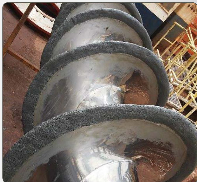
RECUPERAÇÃO DE ROSCA TRANSPORTADORA COM PLASTEEL DIAMANTADO.
