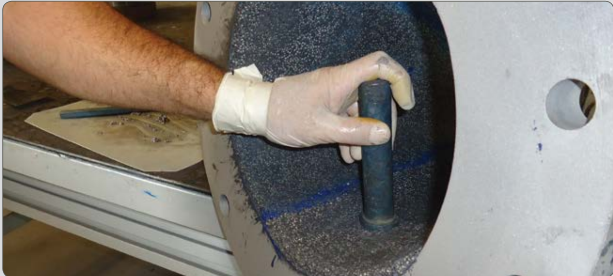
PROTEÇÃO DE BOMBA COM PLASTEEL DIAMANTADO.
