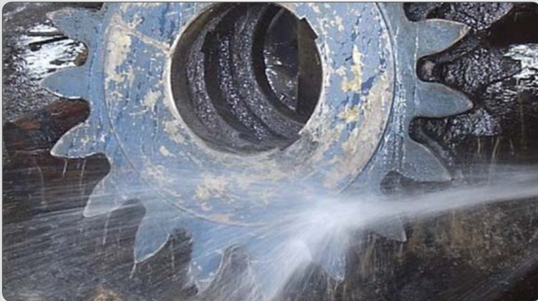
APLICAÇÃO DO DESENGRAXANTE QUIMATIC ED SOLV PARA LIMPEZA DA ENGENHARIA.
