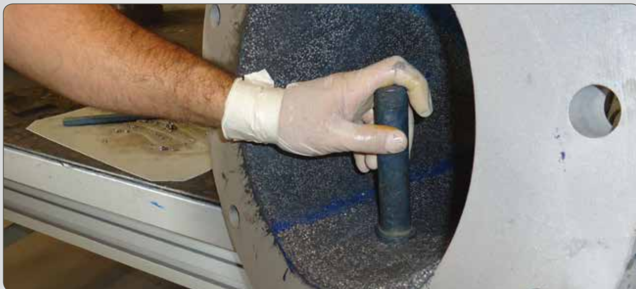
PROTEÇÃO DE BOMBA COM PLASTEEL DIAMANTADO.
