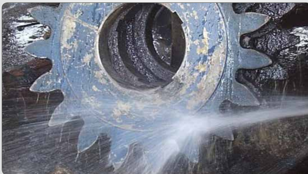
APLICAÇÃO DO DESENGRAXANTE QUIMATIC ED SOLV PARA LIMPEZA DA ENGENHARIA.
